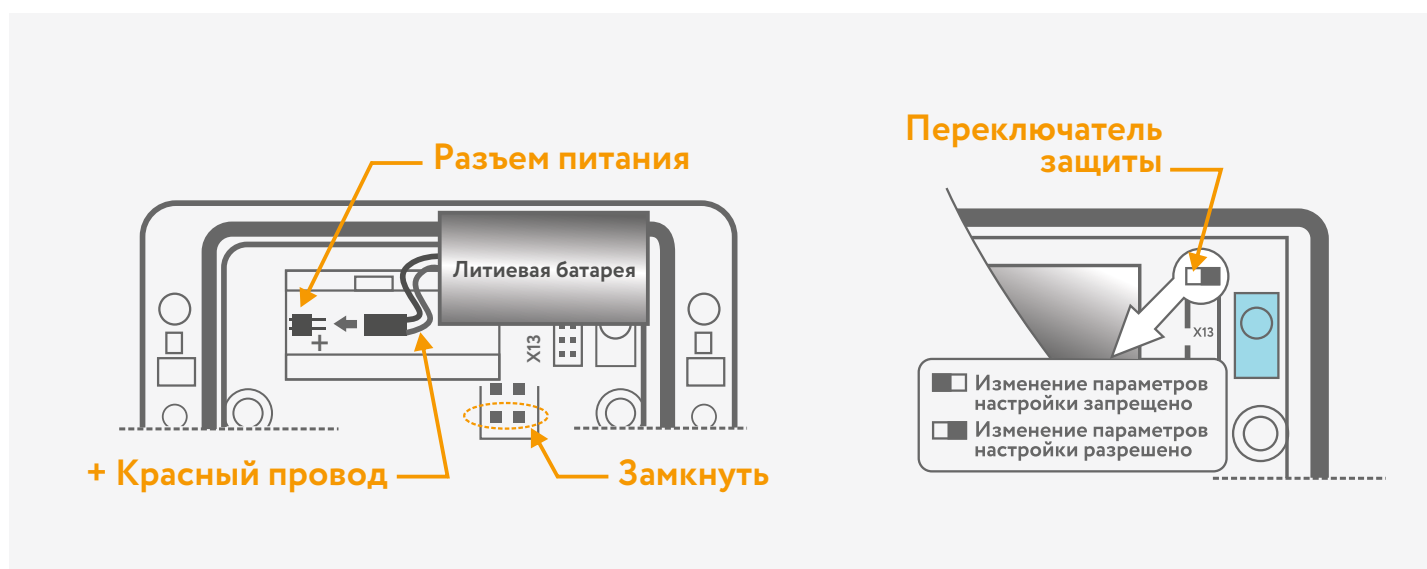
Рис.Л1–Порядок подключения батареи Рис. Л2 – Переключатель защиты
